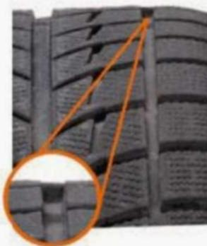
Un neumático con desgaste a nivel de 4 mm, cuando pierde su buena tracción en nieve
