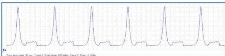
Saque una bujía de encendido, enrosque en su lugar el sensor de presión, arranque el motor, haga una grabación de un minuto y todas las pruebas que antes llevaban horas e incluso días de trabajo están al alcance de un clic.
