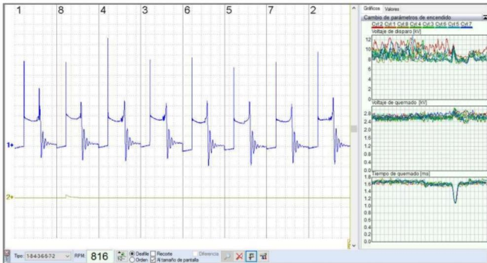
Diagnóstico de encendido. Los pulsos de todos los cilindros ordenados en una pantalla y a la derecha está el cuadro de mediciones donde en tiempo real se muestran los gráficos de los parámetros medidos, cualquier cambio de la señal fuera de lo normal se nota fácilmente de forma visual.
