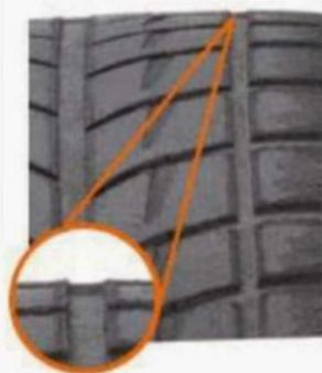
Un neumático con profundidad de banda de rodadura de 1,6 mm, aunque está dentro de las normas, ya perdió su buena tracción en nieve
